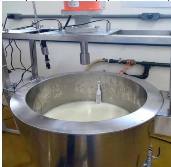
Figura 3 – Tanque de fabricação de queijos utilizado no experimento
