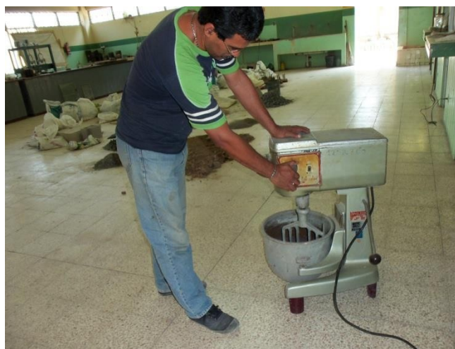
Foto 3.: Mezcladora de mortero
